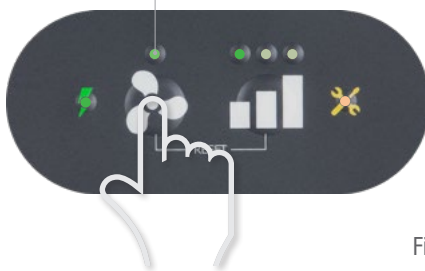
Fig. 9: Presione el botón 🌀 para activar o desactivar la función de ventilación.
