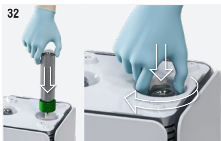
Fig. 32: Positionner les nouveaux tubes ionisants dans leur emplacement en agissant toujours sur la surface en verre accessible avec la main depuis les fentes.
