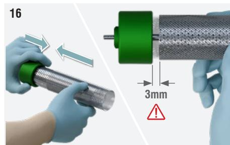
Fig. 17 : Replacer les tubes ionisants dans leur emplacement en agissant toujours sur la surface en verre accessible avec la main depuis les fentes.
