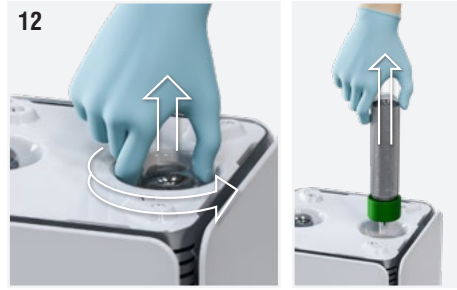
Şek. 12: Özel yuvalardan elle ulaşılabilen cam yüzeyden kavrayarak iyonlaştırıcı jeneratörleri yavaşça sökün.
