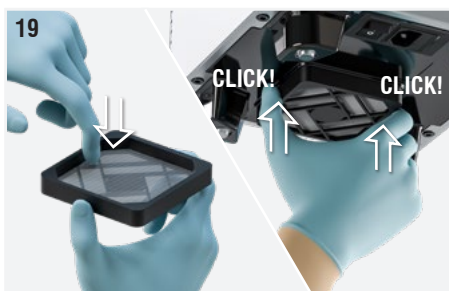
Fig. 19: Riposizionare il filtro a retina all'interno del coprifiltro. Rimontare il coprifiltro con fissaggio a scatto. Premerlo sulla griglia incorporata alla piastra di chiusura finchè non si percepisce lo scatto di avvenuto aggancio tra le parti.
