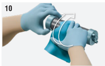
Fig. 10: Pulire il tubo con un panno appena inumidito (che non perda fibre), ruotando leggermente la rete metallica attorno al vetro.
