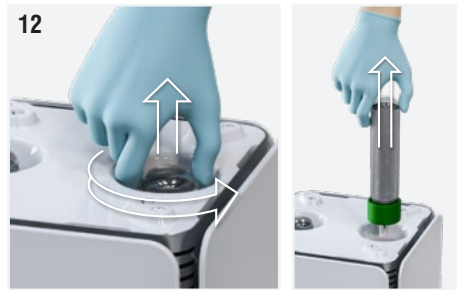
Abb. 12: Die Ionisationsröhren an der Glasoberfläche, die mit der Hand durch die speziellen Schlitze erreicht werden können, vorsichtig abschrauben.
