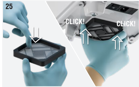
Abb. 25: Den Netzfilter erneut in die Filterabdeckung einsetzen. Die Filterabdeckung mit Schnappverschluss einbauen. Auf das Gitter in der Verschlussplatte drücken, bis zu hören ist, dass sich die Teile ineinander verhakt haben.
