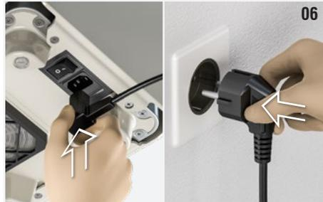
Abb. 7: Der ON/OFF Schalter befindet sich am unteren Teil des Geräts (siehe Kapitel 4). Zum Einschalten des Geräts die Taste 0/1 in die Position I bringen.
