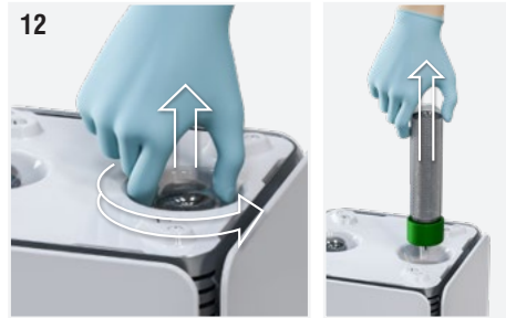
Fig. 12: Desenrosque suavemente los tubos ionizantes actuando sobre la superficie del vidrio a la que se puede acceder con la mano desde las ranuras correspondientes.
