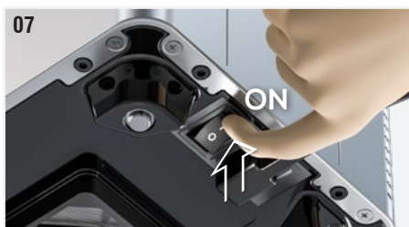
Fig. 7: El interruptor de ON/ OFF se encuentra en la parte inferior del equipo (véase capítulo 4). Para encender el equipo, presione el botón O/I llevándolo a la posición I .
