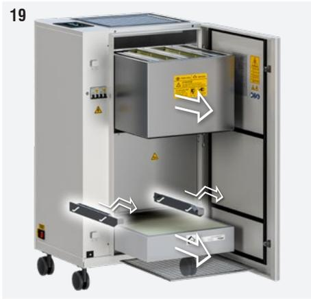
Fig. 20: Coloque los filtros nuevos / limpios. Empuje las pestañas de bloqueo del filtro hacia el interno hasta que escuche un clic.
