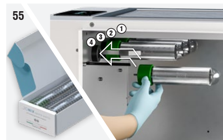
Fig. 55: Atornille suavemente el nuevo tubo ionizante sujetándolo por la base (parte verde).
