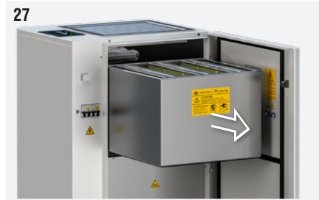
Fig. 27: Extraer el filtro superior para acceder fácilmente a los tubos ionizantes.
