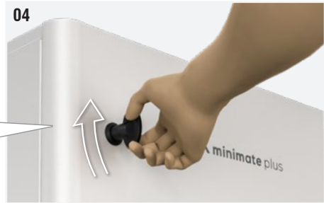
Fig. 4: Tome las llaves sujetas a la rejilla superior y abra el panel frontal de acceso para el mantenimiento.
