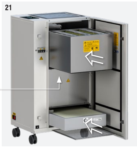
Fig. 21: Coloque los filtros nuevos / limpios. Empuje las pestañas de bloqueo del filtro hacia el interno hasta que escuche un clic.
