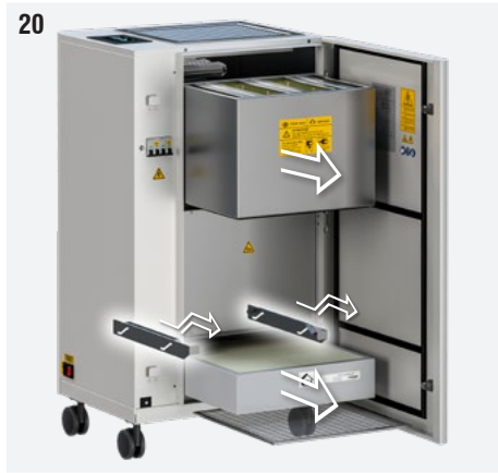
Fig. 20: Tire hacia afuera las pestañas de bloqueo del filtro y extraiga los filtros sucios.
