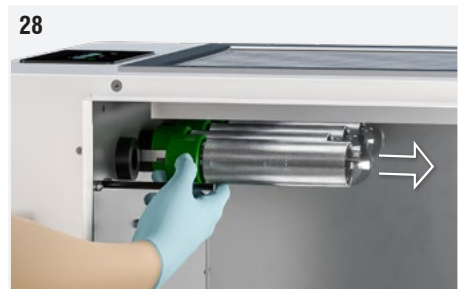
Fig. 28: Desatornille suavemente el tubo ionizante sujetándolo por la base (parte verde).
