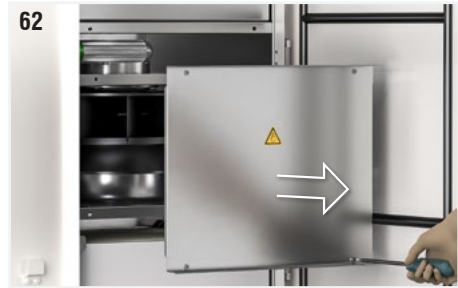
Fig. 62: Retirar el panel que protege el ventilador destornillando los tornillos de fijación.
