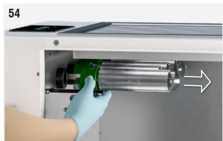
Fig. 54: Desatornille suavemente el tubo ionizante sujetándolo por la base (parte verde).
