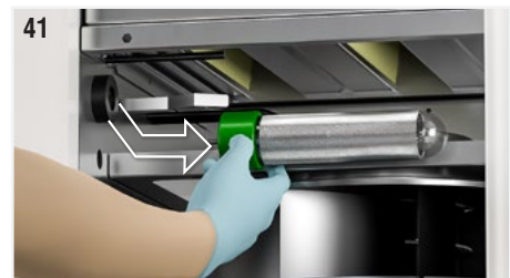
Fig. 41: Desatornille suavemente el tubo ionizante sujetándolo por la base (parte verde). Si la operación es difícil, tire ligeramente del muelle de puesta a tierra para que no entre en contacto con la superficie del tubo.
