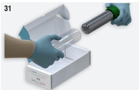
Fig. 32: Vuelva a colocar el **nuevo tubo ionizante** en su asiento atornillándolo, trabajando siempre en la superficie del vidrio que se puede alcanzar con la mano desde las ranuras correspondientes.
