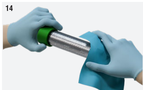
Fig. 14 : Nettoyer le verre avec un chiffon légèrement humidifié.
