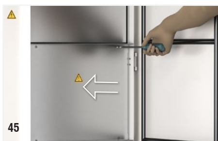
Fig. 45 : Repositionner le panneau qui protège le ventilateur en utilisant les vis de fixation.
