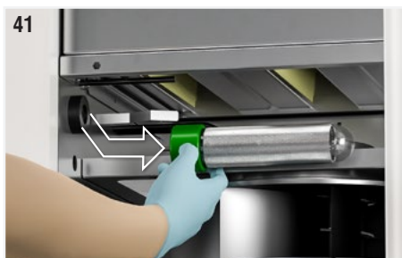
Fig. 41 : Dévisser délicatement le tube ionisant en le saisissant à la base (partie verte).
