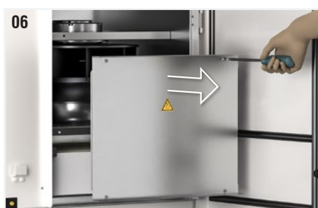
Fig. 6 : Retirer le panneau qui protège le ventilateur en dévissant les vis de fixation.
