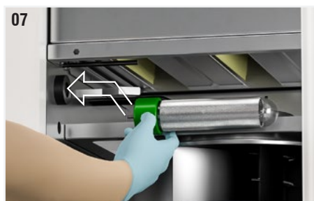
Fig. 7 : Visser doucement le tube ionisant en le prenant par la base (partie verte), en le positionnant dans son emplacement au-dessus du ventilateur. Si l'opération est difficile, veuillez tirer doucement le ressort de mise à la terre afin qu'il ne soit pas en contact avec la surface du tube.
