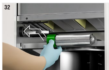
Fig. 32 : Visser doucement le tube ionisant en le prenant par la base (partie verte). Si l'opération est difficile, veuillez tirer doucement le ressort de mise à la terre afin qu'il ne soit pas en contact avec la surface du tube.
