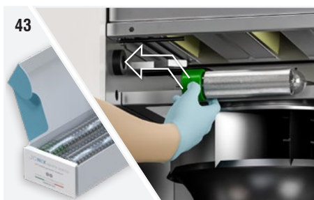
Fig. 43 : Visser doucement le nouveau tube ionisant en le prenant par la base (partie verte).
