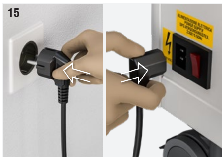
Fig. 15 : Brancher le dispositif au réseau électrique à l'aide du câble d'alimentation fourni.
