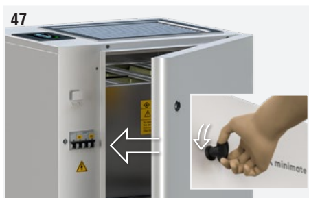
Fig. 47 : Fermer le panneau antérieur d'accès pour l'entretien avec la clé prévue.
