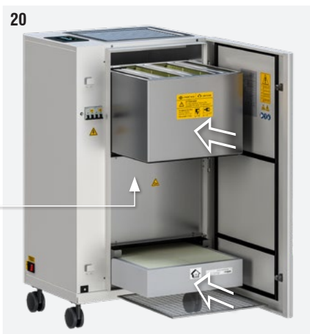
Fig. 20 : Positionner les filtres propres/neufs. Poussez les languettes de blocage du filtre vers l'intérieur jusqu'à ce que vous entendiez un déclic. S'assurer que le joint en caoutchouc du filtre soit tourné vers le bas.
