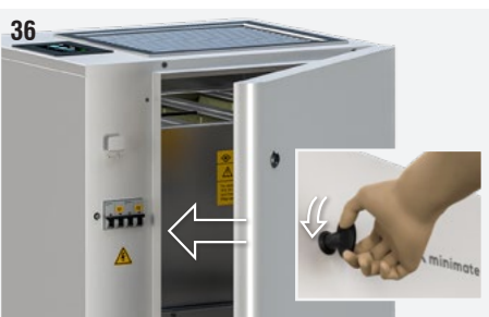
Fig. 36 : Fermer le panneau antérieur d'accès pour l'entretien avec la clé prévue.
