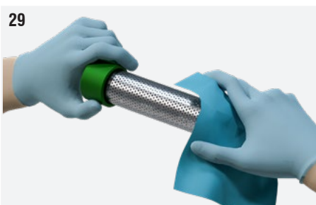
Fig. 29 : Nettoyer le verre avec un chiffon légèrement humidifié.
