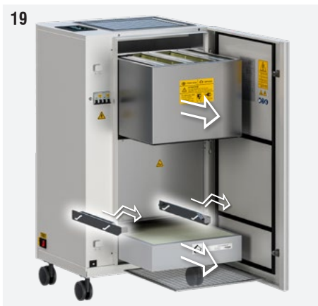
Fig. 19 : Tirer les languettes de blocage des filtres vers l'extérieur et extraire les filtres sales.
