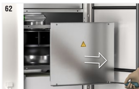
Fig. 62 : Retirer le panneau qui protège le ventilateur en dévissant les vis de fixation.
