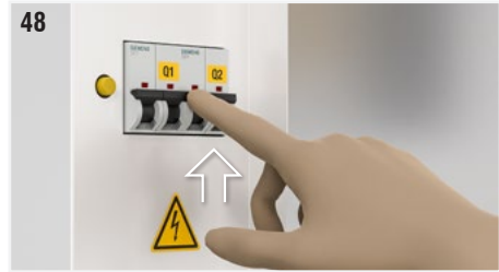
Fig. 48 : Vérifier que les interrupteurs magnétothermiques pour débranchement alimentation ventilateur (Q1) et débranchement alimentation auxiliaires (Q2) soient dans la position ON.
