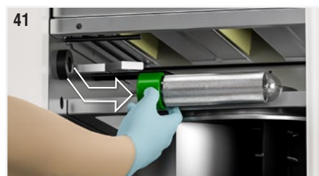
Fig. 41 : Dévisser délicatement le tube ionisant en le saisissant à la base (partie verte).
