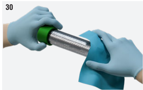
Fig. 30 : Nettoyer le verre avec un chiffon légèrement humidifié.
