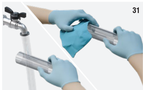
Fig. 31 : Laver le treillis sous un jet d'eau chaude et essuyer soigneusement avec un chiffon qui ne perd pas de fibres.
