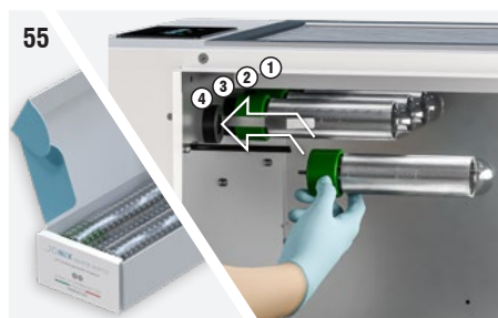
Fig. 55 : Visser doucement le nouveau tube ionisant en le prenant par la base (partie verte).
