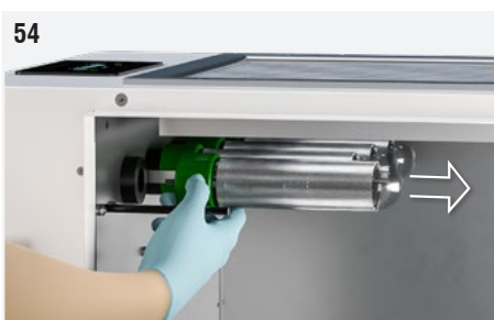
Fig. 54 : Dévisser délicatement le tube ionisant en le saisissant à la base (partie verte).
