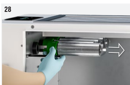
Fig. 28 : Dévisser délicatement le tube ionisant en le saisissant à la base (partie verte).
