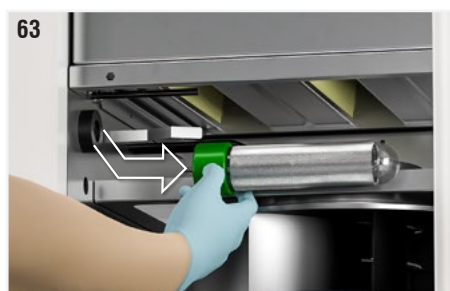
Fig. 63 : Visser doucement le nouveau tube ionisant en le prenant par la base (partie verte).
