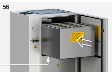
Fig. 56 : Placer le filtre supérieur, assurant que le joint d'étanchéité en caoutchouc est orientée vers le bas.
