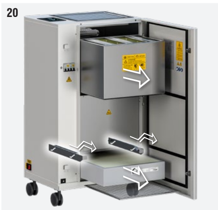
Fig. 20 : Tirer les languettes de blocage des filtres vers l'extérieur et extraire les filtres sales.
