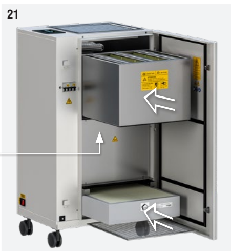
Fig. 21 : Positionner les filtres propres/neufs. Poussez les languettes de blocage du filtre vers l'intérieur jusqu'à ce que vous entendiez un déclic.
