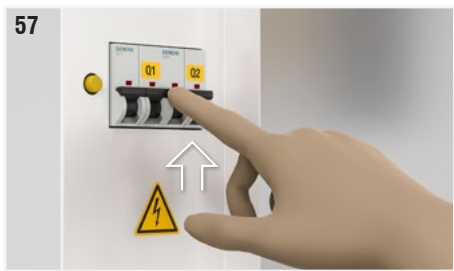
Abb. 57: Sicherstellen, dass die Wärmeschutzschalter zum Abschalten der Lüfterstromversorgung (Q1) und der Hilfsstromversorgung (Q2) auf Position ON stehen.
