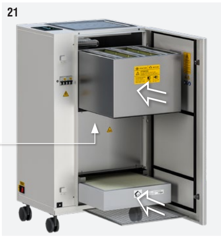
Abb. 21: Die neuen / sauberen Filter einsetzen. Die Befestigungslosche der Filter nach innen schieben, bis sie einrastet.
