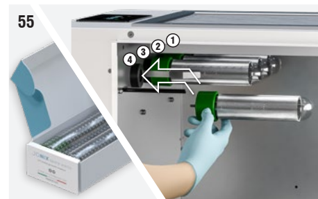
Abb. 55: Die neue Ionisationsröhre an der Unterseite (grüner Teil) ergreifen und vorsichtig anschrauben. Wenn der Vorgang schwierig sein sollte, leicht an der Erdungsfeder ziehen, sodass sie die Oberfläche der Röhre nicht berührt.
