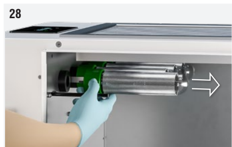
Abb. 28: Die Ionisationsröhre an der Unterseite (grüner Teil) ergreifen und vorsichtig abschrauben. Wenn der Vorgang schwierig sein sollte, leicht an der Erdungsfeder ziehen, sodass sie die Oberfläche der Röhre nicht berührt.
