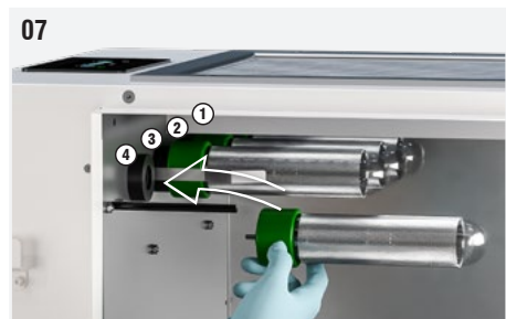
Abb. 7: Schrauben Sie die Röhre vorsichtig fest Gend Ionisieren durch Greifen an der Basis (Teil Grün). Wenn der Vorgang schwierig sein sollte, leicht an der Erdungsfeder ziehen, sodass sie die Oberfläche der Röhre nicht berührt.
