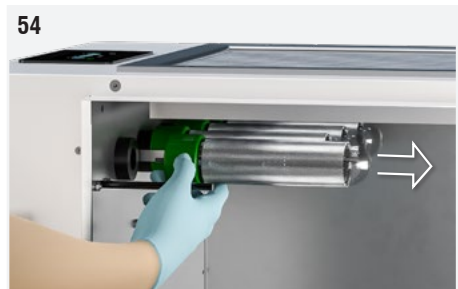
Abb. 54: Die Ionisationsröhre an der Unterseite (grüner Teil) ergreifen und vorsichtig abschrauben. Wenn der Vorgang schwierig sein sollte, leicht an der Erdungsfeder ziehen, sodass sie die Oberfläche der Röhre nicht berührt.
