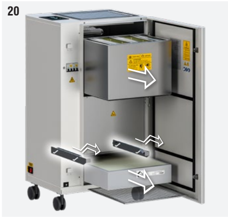
Abb. 20: Die Befestigungslosche der Filter nach außen ziehen und die schmutzigen Filter herausziehen.
