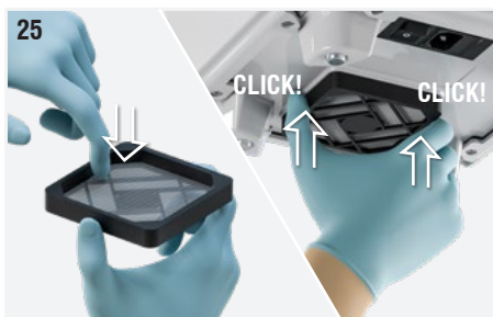
Fig. 25: Riposizionare il filtro a retina all'interno del coprifiltro. Rimontare il coprifiltro con fissaggio a scatto. Premerlo sulla griglia incorporata alla piastra di chiusura finchè non si percepisce lo scatto di avvenuto aggancio tra le parti.
