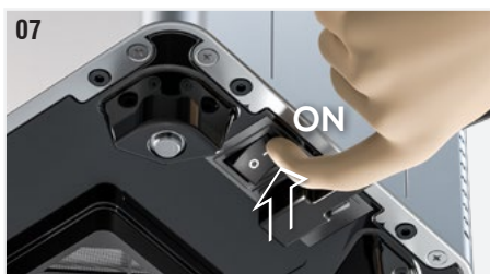
Fig. 7: L'interruttore di ON/OFF è situato sulla parte inferiore dell'apparecchio (vedi capitolo 4). Per accendere l'apparecchio agire sul pulsante O/I portandolo in posizione I .
