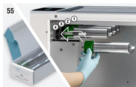
Fig. 55: Avvitare delicatamente il nuovo tubo ionizzante , afferrandolo alla base (parte verde). Se l'operazione risulta difficoltosa, tirare leggermente la molla di messa a terra in modo tale che non faccia contatto con la superficie del tubo.
