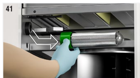
Fig. 41: Svitare delicatamente il tubo ionizzante afferrandolo alla base (parte verde). Se l'operazione risulta difficoltosa, tirare leggermente la molla di messa a terra in modo tale che non faccia contatto con la superficie del tubo.
