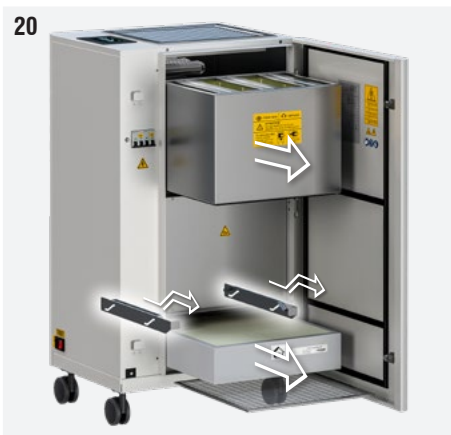
Fig. 20: Tirare verso l'esterno le linguette blocca filtri edstrarre i filtri sporchi.
