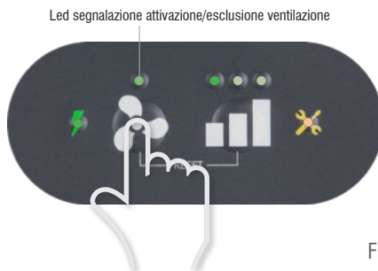
Fig. 9: Premere il pulsante 🌀 per attivare o escludere la funzione ventilazione.
