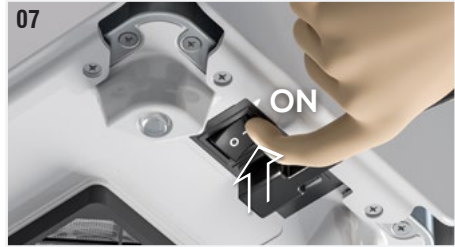
Şek. 7: AÇMA/KAPAMA anahtarı cihazın altında bulunur (bkz. bölüm 4). Cihaza güç vermek için 0/1 tuşunu 1 konumuna getirin.
