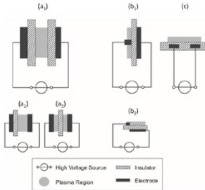
Figura 1 – esempi di configurazioni di reattori DBD: (a) volume DBD (1-symmetric, 2-asymmetric, 3-floated dielectric); (b) surface DBD (1-symmetric, 2-asymmetric 'actuator' design); (c) coplanar discharge (Brandenburg R. , 2017)
