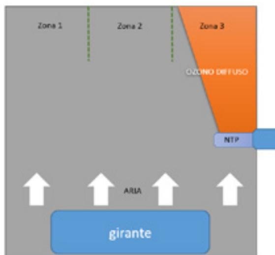
Figura 15 – ipotesi diffusione ozono all'interno del fan coil
