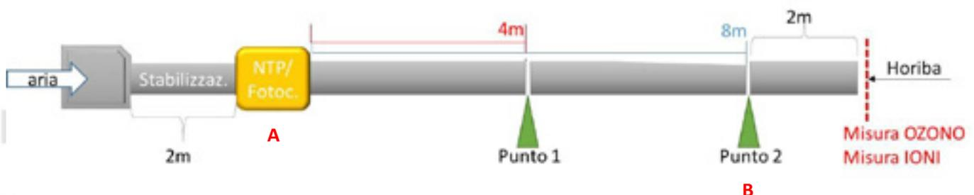
La misura della **concentrazione di ozono** è stata fatta mediante un analizzatore in continuo **HORIBA – APOA – 370**, equipaggiato con sonda di aspirazione posta al punto di uscita dell'aria e nel centro della tubazione. Il range di lettura dello strumento varia da 0,0001 ppm a 3 ppm.
