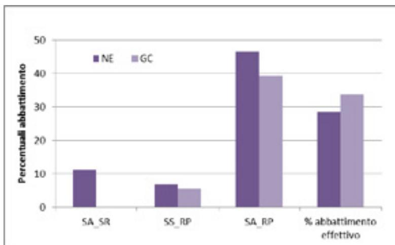
**Figura 26. Risultati prove condotte sul rifiuto LO espresse come percentuali di abbattimento, valutate nei punti di campionamento 1 e 3.**
