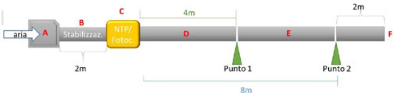
Un ventilatore (A) è in grado di generare flussi di aria a diversa portata, e quindi a diversa velocità, all'interno del tubo.
