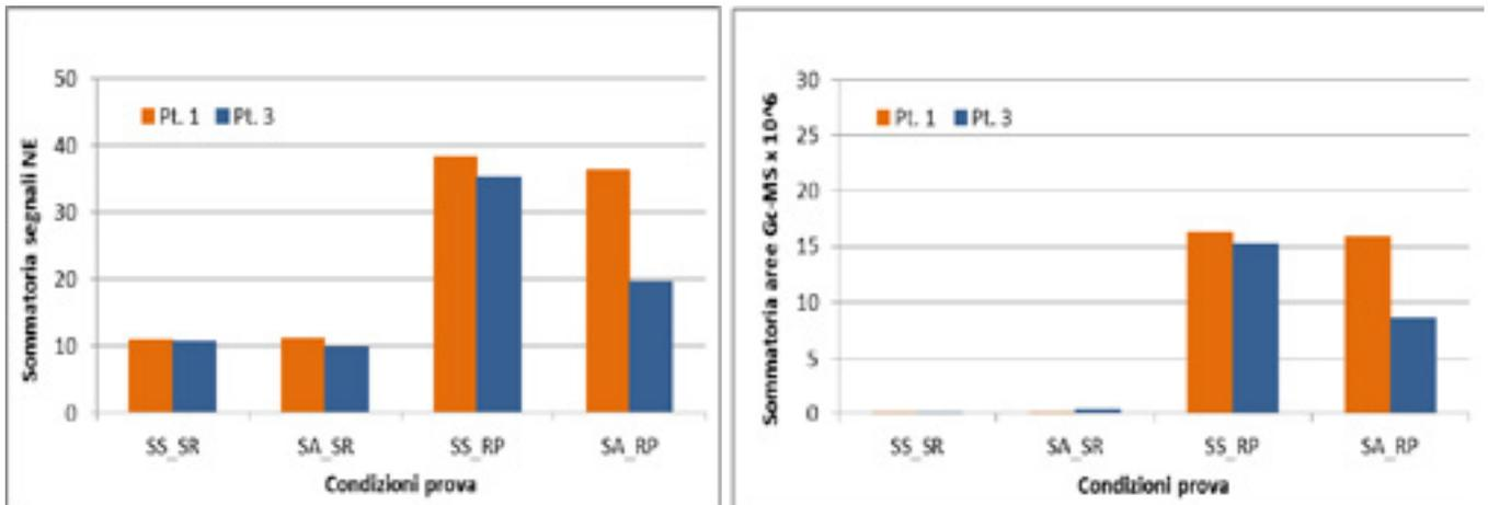
Figura 27. Risultati prove condotte sul rifiuto LA (NE a sinistra; GC-MS a destra).
