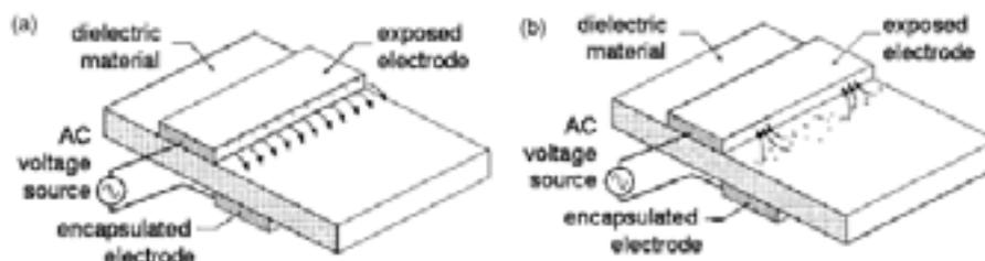
Figura 3 - Funzionamento del DBD: (a) semiciclo negativo e (b) semiciclo positivo.
