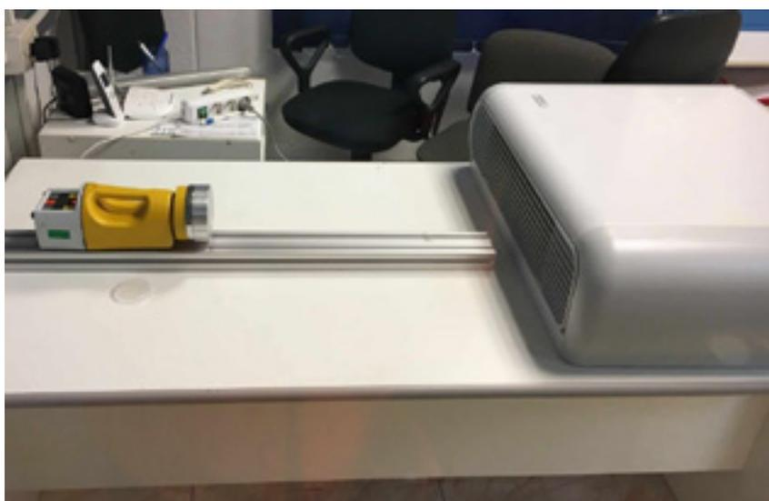
Figura 1 – prelievo di aerosol mediante SAS Super 100
