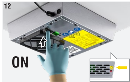
Abb. 12: Den Schalter auf ON bringen, um zu prüfen, ob das Gerät mit Spannung versorgt wird. Wenn die Installation korrekt ist, leuchte die gelbe LED auf und die rote LED zur Alarmmeldung bleibt aus.
