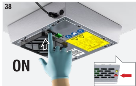
Abb. 38: Den Schalter auf ON bringen, um zu prüfen, ob das Gerät mit Spannung versorgt wird. Den Betrieb des Geräts überprüfen; es muss ein leichtes Zischen aus der Ionisationsröhre zu hören und der vom Lüfter erzeugte Luftstrom zu spüren sein.
