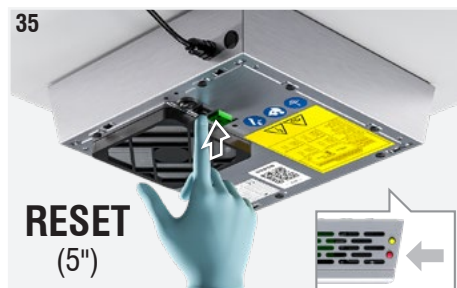
Abb. 39: Die Reset-Taste mindestens 5 Sekunden lang gedrückt halten, bis die Alarm-LED (rote LED) aus geht.
