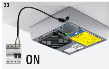
Abb. 37: Auf den Sicherheitswärmeschutzschalter am Stromkreis vor dem Gerät einwirken, um die Stromversorgung wiederherzustellen.
