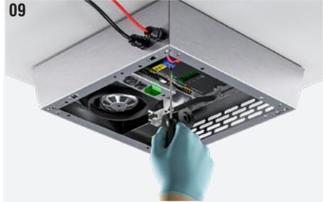
Fig. 10: Tome el tubo ionizante, retire el plástico de burbujas y verifique la integridad del vidrio.
