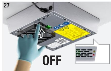
Fig. 28: Desconecte la fuente de alimentación actuando sobre el interruptor magnetotérmico de seguridad situado en el circuito aguas arriba del dispositivo. Asegúrese de que la fuente de alimentación no se pueda restaurar accidentalmente.
