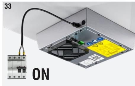
Fig. 38 : Amener l'interrupteur sur ON pour vérifier la présence de tension dans le dispositif. Contrôler le fonctionnement du dispositif : on doit entendre un léger grésillement provenant du tube d'ionisation et on doit percevoir le flux d'air généré par le ventilateur.
