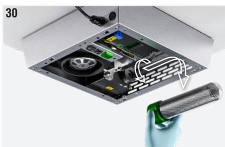
Fig. 31 : Dégager le treillis à l'extérieur du tube : si l'opération est difficile, tourner le treillis autour du verre.
