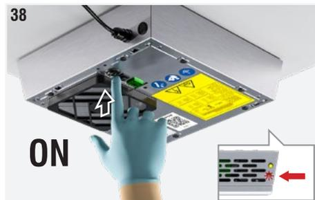
Fig. 39 : Tenir la touche de reset enfoncée pendant au moins 5 secondes jusqu'à ce que la LED alarmes (LED rouge) s'éteigne.
