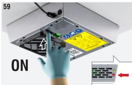
Fig. 60 : Tenir la touche de reset enfoncée pendant au moins 5 secondes jusqu'à ce que la LED alarmes (LED rouge) s'éteigne.
