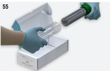
Fig. 56 : Visser doucement le tube ionisant en le prenant par la base (partie verte). Si l'opération est difficile, veuillez tirer doucement le ressort de mise à la terre afin qu'il ne soit pas en contact avec la surface du tube.
