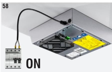
Fig. 59 : Amener l'interrupteur sur ON pour vérifier la présence de tension dans le dispositif. Contrôler le fonctionnement du dispositif : on doit entendre un léger grésillement provenant du tube d'ionisation et on doit percevoir le flux d'air généré par le ventilateur.
