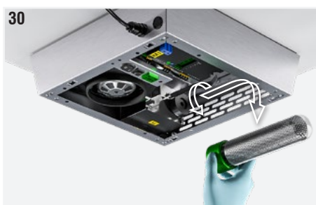
Fig. 30: Svitare delicatamente il tubo ionizzante afferrandolo alla base (parte verde).
