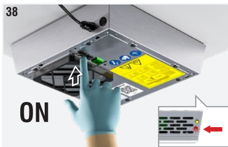
Fig. 38: Posizionare l'interruttore su ON per verificare la presenza di tensione nel dispositivo. Verificare il funzionamento del dispositivo, deve essere udibile un leggero sfrigolio provenire dal tubo ionizzante e si percepirà il flusso d'aria generato dal ventilatore.
