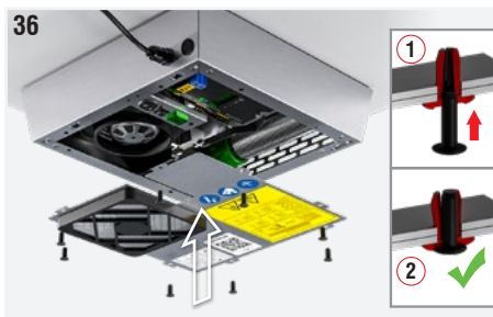
Fig. 36: Rimontare la piastra di chiusura riavvitando i rivetti di fissaggio in plastica.
