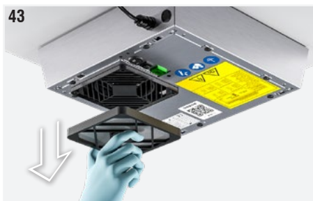
Fig. 43: Rimuovere il copri filtro premendo sui lati e tirandolo verso di sé.
