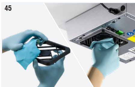
Fig. 45: Passare con un panno in microfibra umido il coprifiltro in plastica e la griglia incorporata alla piastra di chiusura.
