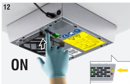
Fig. 12: Posizionare l'interruttore su ON per verificare la presenza di tensione nel dispositivo. Se l'installazione è corretta, il led giallo si accende e il led rosso di segnalazione allarme non si accende.
