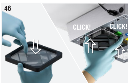
Fig. 46: Riposizionare il filtro a retina all'interno del coprifiltro. Rimontare il coprifiltro con fissaggio a scatto. Premerlo sulla griglia incorporata alla piastra di chiusura finchè non si percepisce lo scatto di avvenuto aggancio tra le parti.
