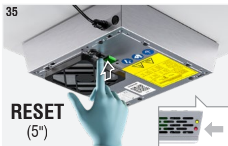
Fig. 39: Tenere premuto il tasto di reset per almeno 5 secondi finchè non si spegne il led allarmi (led rosso).
