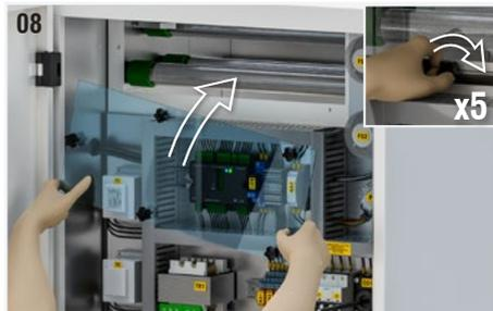
Abb. 9: Die 2 Knöpfe abschrauben, die die untere Rückwand geschlossen halten für den Wartungszugang öffnen. Heben Sie die Platte an und ziehen Sie sie dann zu sich hin, um sie zu entfernen.
