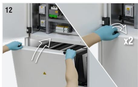
Abb. 13: Sicherstellen, dass die Wärmeschutzschalter zum Abschalten der Lüfterstromversorgung (Q1) und der Hilfsstromversorgung (Q2) auf Position ON stehen.
