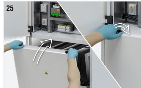
Abb. 26: Die Frontplatte für den Wartungszugriff schließen.
