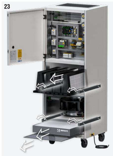
Abb. 24: Die neuen / sauberen Filter einsetzen. Die Befestigungslasche der Filter nach innen schieben, bis sie einrastet.
