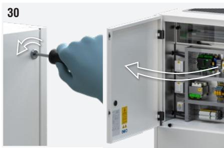
Abb. 31: Schrauben Sie dem Türknauf ab und entfernen Sie die innere Plexiglasscheibe, um Zugang zu den Ionisationsröhren zu erhalten.
