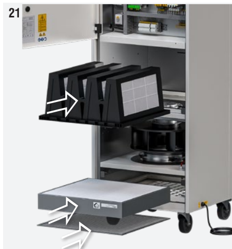
Abb. 21: Die neuen / sauberen Filter einsetzen. Die Befestigungslasche der Filter nach innen schieben, bis sie einrastet.
