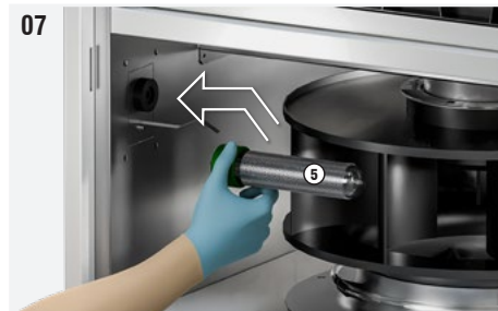
Abb. 7: Die Ionisationsröhre an der Unterseite (grüner Teil) ergreifen und vorsichtig in ihrem Sitz über dem Lüfter anschrauben. Wenn der Vorgang schwierig sein sollte, leicht an der Erdungsfeder ziehen, sodass sie die Oberfläche der Röhre nicht berührt.
