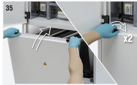
Abb. 35: Die Abdeckplatte erneut positionieren. Die Knöpfe anschrauben.
