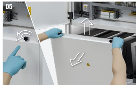
Abb. 5: Die 2 Knöpfe abschrauben, die die untere Rückwand geschlossen halten für den Wartungszugang öffnen. Heben Sie die Platte an und ziehen Sie sie dann zu sich hin, um sie zu entfernen.
