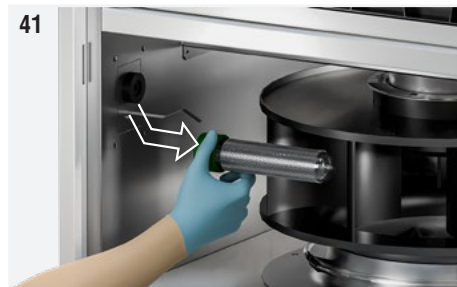
Abb. 41: Die Ionisationsröhre an der Unterseite (grüner Teil) ergreifen und vorsichtig abschrauben. Wenn der Vorgang schwierig sein sollte, leicht an der Erdungsfeder ziehen, sodass sie die Oberfläche der Röhre nicht berührt.
