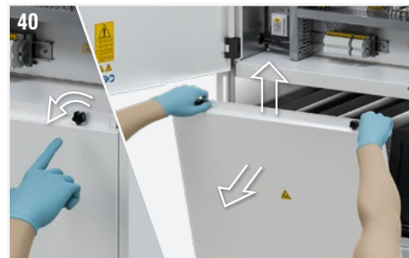
Abb. 40: Die 2 Knöpfe abschrauben, die die untere Rückwand geschlossen halten für den Wartungszugang öffnen. Heben Sie die Platte an und ziehen Sie sie dann zu sich hin, um sie zu entfernen.
