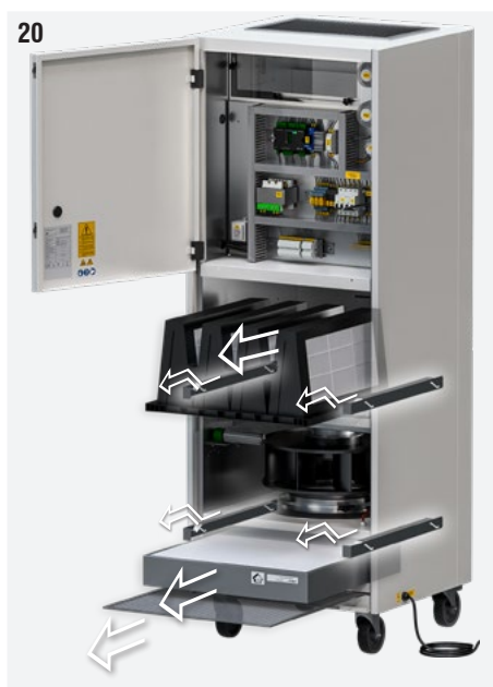
Abb. 20: Die Befestigungslasche der Filter nach außen ziehen and die schmutzigen Filter herausziehen.
