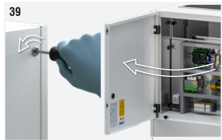
Abb. 39: Zum Öffnen der obere Rückwand einen Schraubenzieher verwenden.
