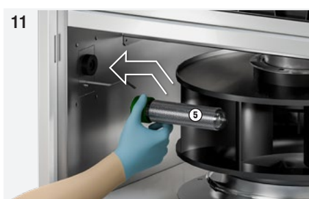
Fig. 11: Atornille suavemente el tubo ionizante sujetándolo por la base (parte verde), colocándolo en su asiento sobre el ventilador.
