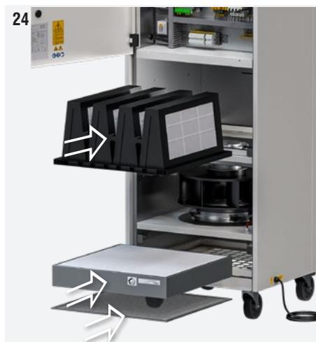
Fig. 24: Coloque los filtros nuevos / limpios. Empuje las pestañas de bloqueo del filtro hacia el interno hasta que escuche un clic.
