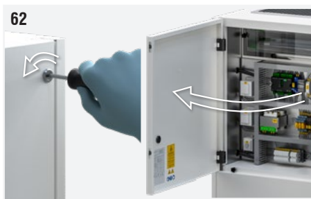
Fig. 62: Utilice un destornillador para abrir el panel superior trasero.
