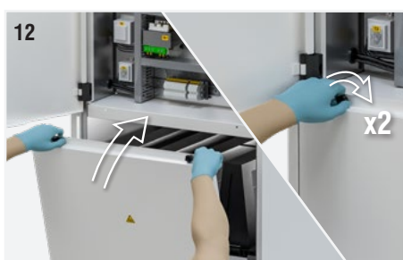
Fig. 12: Vuelva a colocar el panel de cubierta. Vuelva a atornillar las perillas.
