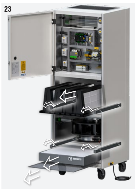
Fig. 23: Tire hacia afuera las pestañas de bloqueo del filtro y extraiga los filtros sucios.
