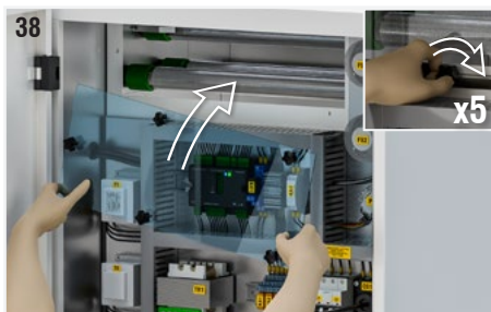
Fig. 38: Vuelva a colocar el panel de plexiglás. Vuelva a atornillar las perillas.
