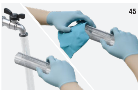
Fig. 45 : Laver le treillis sous un jet d'eau chaude et essuyer soigneusement avec un chiffon qui ne perd pas de fibres.
