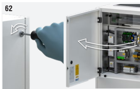
Fig. 62 : Utiliser un tournevis pour ouvrir le panneau supérieur arrière.
