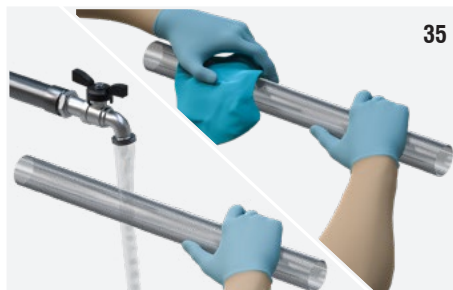
Fig. 35 : Laver le treillis sous un jet d'eau chaude et essuyer soigneusement avec un chiffon qui ne perd pas de fibres.
