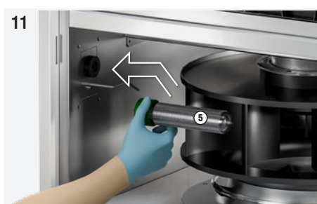
Fig. 11 : Visser doucement le tube ionisant en le prenant par la base (partie verte), en le positionnant dans son emplacement au-dessus du ventilateur.
