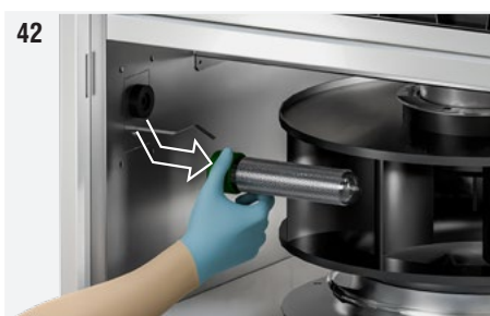
Fig. 42 : Dévisser délicatement le tube ionisant en le saisissant à la base (partie verte).
