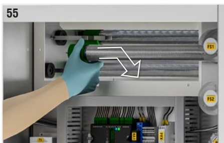
Fig. 55 : Dévisser délicatement le tube ionisant en le saisissant à la base (partie verte).
