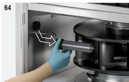
Fig. 64 : Dévisser délicatement le tube ionisant en le saisissant à la base (partie verte).
