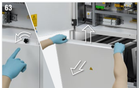
Fig. 63 : Dévisser les 2 poignées qui tiennent le panneau inférieur arrière d'accès pour l'entretien. Soulever puis tirer vers soi pour retirer le panneau.
