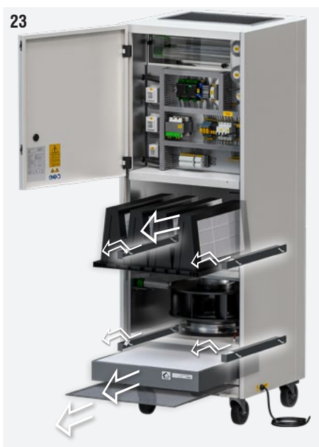
Fig. 23 : Tirer les languettes de blocage des filtres vers l'extérieur et extraire les filtres sales.
