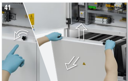
Fig. 41 : Dévisser les 2 poignées qui tiennent le panneau inférieur arrière d'accès pour l'entretien. Soulever puis tirer vers soi pour retirer le panneau.
