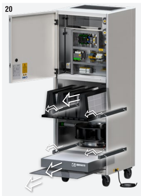
Fig. 20 : Tirer les languettes de blocage des filtres vers l'extérieur et extraire les filtres sales.
