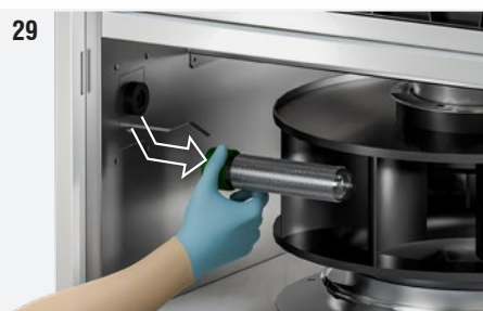
Fig. 29 : Dévisser délicatement le tube ionisant en le saisissant à la base (partie verte).
