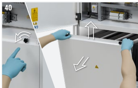
Fig. 40: Svitare le 2 manopole che tengono chiuso il pannello inferiore posteriore di accesso per la manutenzione. Alzare e quindi tirare verso di se per rimuovere il pannello.
