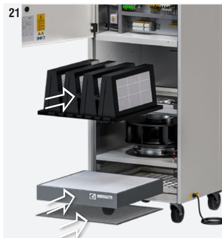
Fig. 21: Posizionare i filtri nuovi / puliti. Spingere le linguette ferma filtro verso l'interno finché non si avverte uno scatto.
