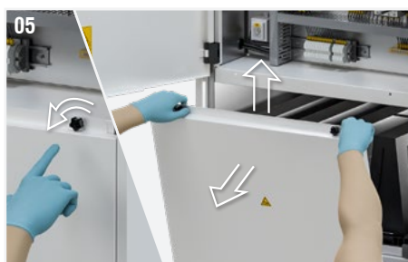
Fig. 5: Svitare le 2 manopole che tengono chiuso il pannello inferiore posteriore di accesso per la manutenzione. Alzare e quindi tirare verso di se per rimuovere il pannello.
