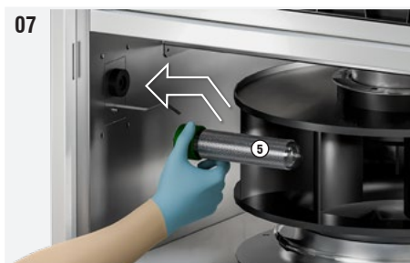
Fig. 7: Avvitare delicatamente il tubo ionizzante afferrandolo alla base (parte verde), posizionandolo nella sua sede sopra il ventilatore. Se l'operazione risulta difficoltosa, tirare leggermente la molla di messa a terra in modo tale che non faccia contatto con la superficie del tubo.
