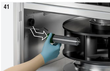
Fig. 41: Svitare delicatamente il tubo ionizzante afferrandolo alla base (parte verde). Se l'operazione risulta difficoltosa, tirare leggermente la molla di messa a terra in modo tale che non faccia contatto con la superficie del tubo.
