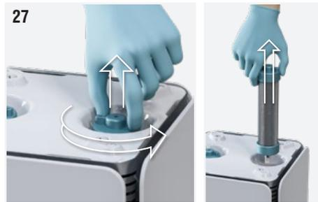
Abb. 28: Nehmen Sie die neuen Ionisationsröhren aus der Verpackung und behandeln Sie sie vorsichtig, da sie zerbrechlich sind.
