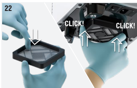
Abb. 22: Den Netzfilter erneut in die Filterabdeckung einsetzen. Die Filterabdeckung mit Schnappverschluss einbauen. Auf das Gitter in der Verschlussplatte drücken, bis zu hören ist, dass sich die Teile ineinander verhakt haben.
