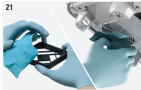
Fig. 22: Vuelva a colocar el filtro de malla al interno de la tapa del filtro. Vuelva a colocar la tapa del filtro con cierre a presión. Presiónelo sobre la rejilla incorporada en la placa de cierre hasta escuchar el clic del acoplamiento entre las piezas.
