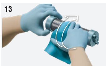
Fig. 13: Limpiar el tubo con un paño ligeramente húmedo (que no suelte fibras), girando ligeramente la malla metálica alrededor del cristal.
