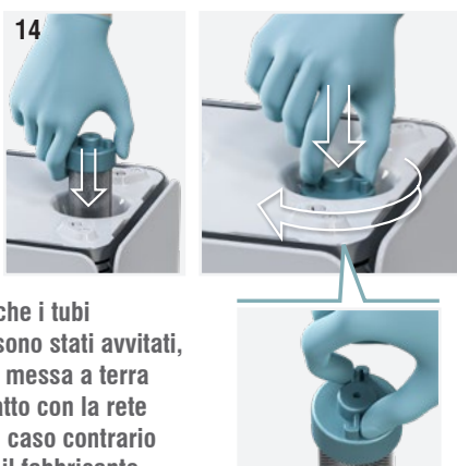
Fig. 14: Riposizionare i tubi ionizzanti nella loro sede riavvitandoli agendo sempre sul tappo di sicurezza.
