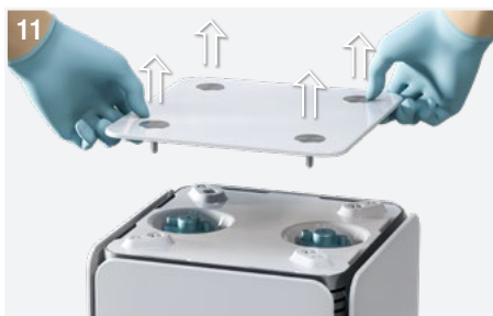
Fig. 11: Rimuovere il coperchio tirandolo verso l'alto.
