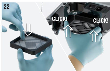
Fig. 22: Riposizionare il filtro a retina all'interno del coprifiltro. Rimontare il coprifiltro con fissaggio a scatto. Premerlo sulla griglia incorporata alla piastra di chiusura finchè non si percepisce lo scatto di avvenuto aggancio tra le parti.
