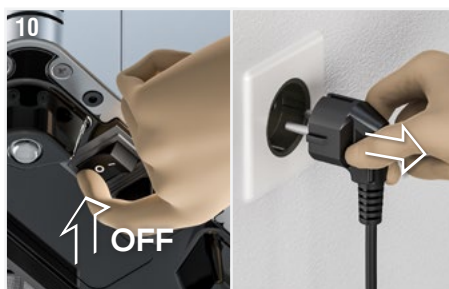
Fig. 10: Spegner il dispositivo ionizzante agendo sull'interruttore di On/Off portandolo nella posizione 0 . Posizionare il dispositivo su di un piano orizzontale. Staccare la spina di alimentazione collegata alla rete elettrica.
