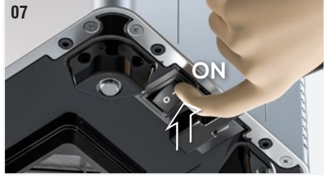
Şek. 7: AÇMA/KAPAMA anahtarı cihazın altında bulunur (bkz. bölüm 4). Cihazı açmak için 0/I düğmesine basarak I konumuna getirin; cihazın içinden hafif bir tıslama sesi gelecek ve kontrol panelindeki led yanarak cihazın açıldığını gösterecektir.
