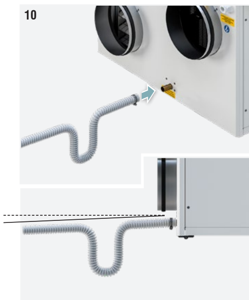
Fig. 10: Installare lo scarico condensa con tubo in gomma flessibile e diametro interno minimo di 16 mm. Eseguire sul tubo di scarico un sifone con battente almeno pari alla prevalenza in aspirazione del ventilatore. Lo scarico condensa deve essere isolato se passa attraverso spazi non riscaldati per prevenire il congelamento.
