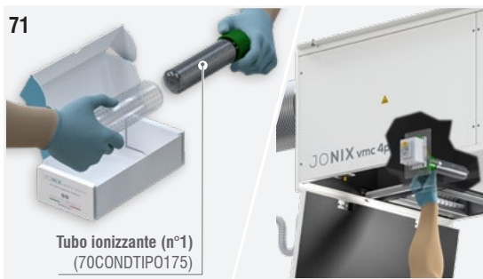
Fig. 71: Avvitare delicatamente il nuovo tubo ionizzante, afferrandolo alla base (parte verde).
