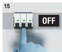
Fig. 15: Sezionare l'alimentazione elettrica agendo sul magnetotermico di sicurezza posizionato sul circuito a monte del dispositivo. Accertarsi che l'alimentazione elettrica non possa essere ripristinata in modo accidentale.
