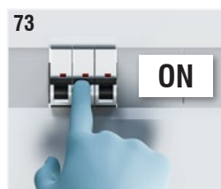
Fig. 73: Agire sul magnetotermico di sicurezza posizionato sul circuito a monte del dispositivo per ripristinare l'alimentazione elettrica.
