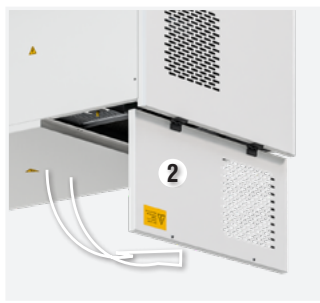
Fig. 43: Aprire il pannello di ispezione lato esterno (2).
