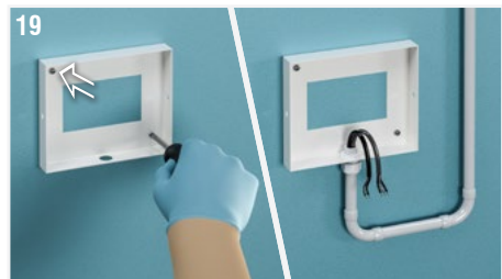
Fig. 19: Fissare la cassa al supporto nella posizione desiderata utilizzando gli appositi fori. Scegliere il sistema di fissaggio idoneo al tipo di superficie.
