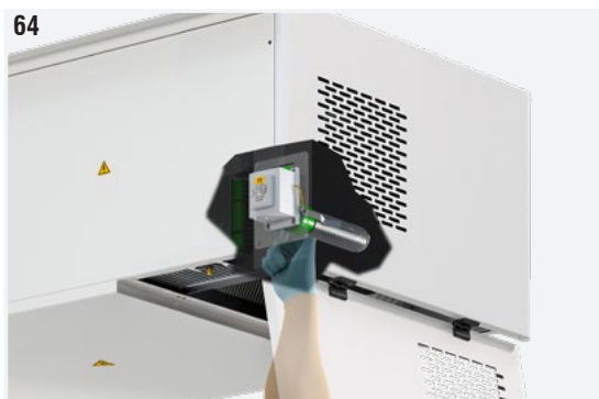
Fig. 64: Svitare delicatamente il tubi ionizzanti afferrandoli alla base (parte verde).
