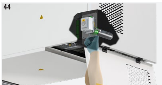
Fig. 44: Svitare delicatamente i tubi ionizzanti afferrandoli alla base (parte verde).
