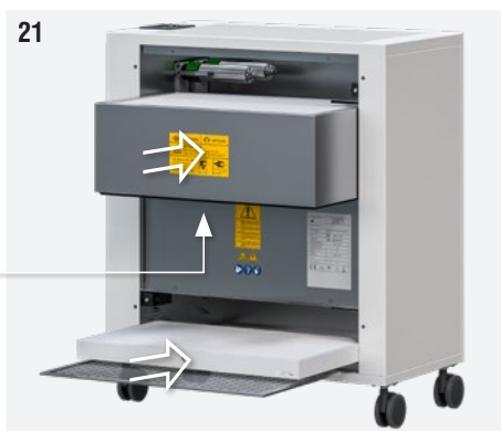
Fig. 21: Posizionare i filtri nuovi / puliti.
