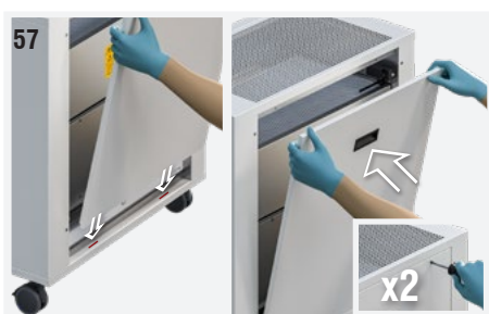
Fig. 57: Chiudere il pannello anteriore di accesso per la manutenzione posizionando le linguette nella sede inferiore, accompagnare la chiusura utilizzando la maniglia e fissare le due viti superiori.
