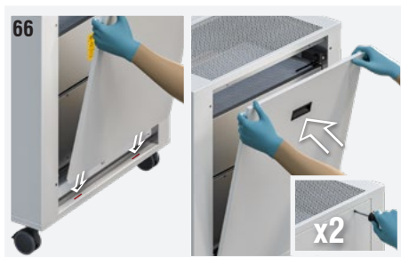
Fig. 66: Chiudere il pannello anteriore di accesso per la manutenzione posizionando le linguette nella sede inferiore, accompagnare la chiusura utilizzando la maniglia e fissare le due viti superiori.
