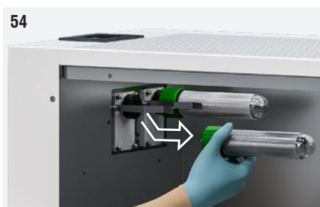
Fig. 54: Svitare delicatamente il tubo ionizzante afferrandolo alla base (parte verde). Se l'operazione risulta difficoltosa, tirare leggermente la molla di messa a terra in modo tale che non faccia contatto con la superficie del tubo.
