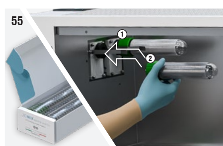
Fig. 55: Avvitare delicatamente il nuovo tubo ionizzante , afferrandolo alla base (parte verde). Se l'operazione risulta difficoltosa, tirare leggermente la molla di messa a terra in modo tale che non faccia contatto con la superficie del tubo.
