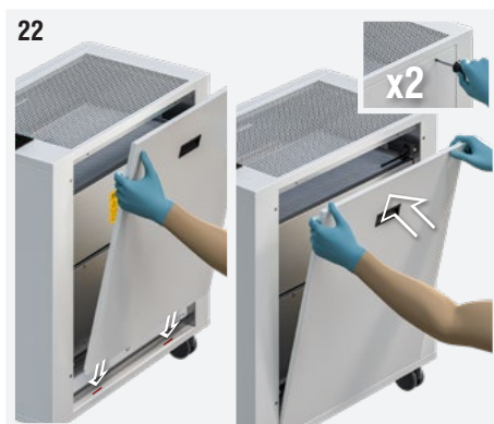
Fig. 22: Chiudere il pannello anteriore di accesso per la manutenzione posizionando le linguette nella sede inferiore, accompagnare la chiusura utilizzando la maniglia e fissare le due viti superiori.
