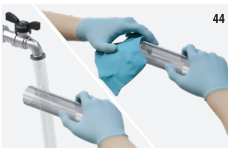
Fig. 44: Lavare la rete sotto un getto di acqua calda e asciugare accuratamente con un panno che non perda fibre.
