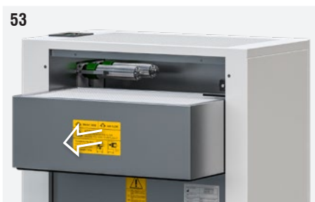
Fig. 53: Estrarre il filtro superiore per accedere agevolmente ai tubi ionizzanti.
