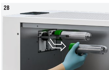
Fig. 28: Svitare delicatamente il tubo ionizzante afferrandolo alla base (parte verde). Se l'operazione risulta difficoltosa, tirare leggermente la molla di messa a terra in modo tale che non faccia contatto con la superficie del tubo.
