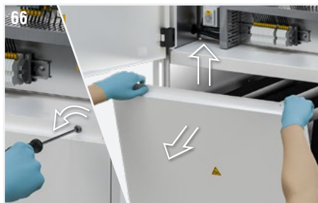
Fig. 66: Svitare le 2 viti che tengono chiuso il pannello inferiore posteriore di accesso per la manutenzione. Alzare e quindi tirare verso di se per rimuovere il pannello.
