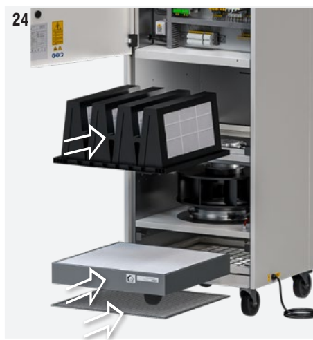
Fig. 24: Posizionare i filtri nuovi / puliti. Spingere le linguette ferma filtro verso l'interno finché non si avverte uno scatto.
