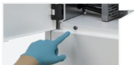
Fig. 9: Svitare le 2 viti che tengono chiuso il pannello inferiore posteriore di accesso per la manutenzione. Alzare e quindi tirare verso di se per rimuovere il pannello.
