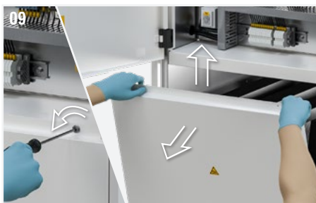
Fig. 9: Svitare le 2 viti che tengono chiuso il pannello inferiore posteriore di accesso per la manutenzione. Alzare e quindi tirare verso di se per rimuovere il pannello.
