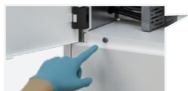
Fig. 66: Svitare le 2 viti che tengono chiuso il pannello inferiore posteriore di accesso per la manutenzione. Alzare e quindi tirare verso di se per rimuovere il pannello.
