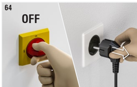
Fig. 64: Spegner il dispositivo agendo sul sezionatore. Staccare la spina di alimentazione collegata alla rete elettrica.
