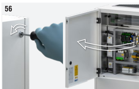
Fig. 56: Utilizzare un cacciavite per aprire il pannello superiore posteriore.
