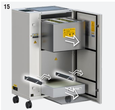
Fig. 15: Tirare verso l'esterno le linguette blocca filtri edstrarre i filtri sporchi.
