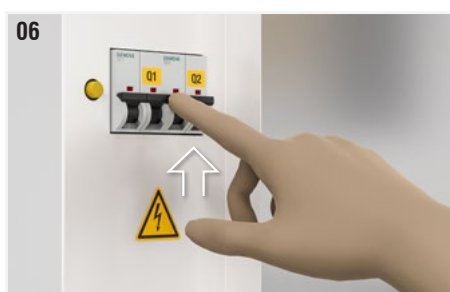
Fig. 6: Verificare che gli interruttori magnetotermici per stacco alimentazione ventilatore (Q1) e stacco alimentazione ausiliari (Q2) siano in posizione ON.
