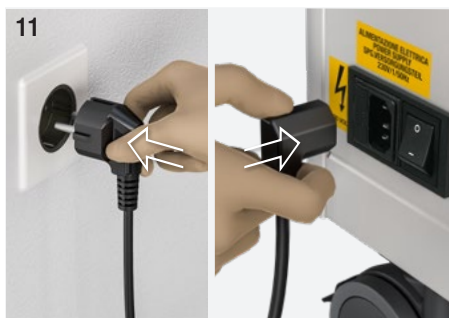
Fig. 11: Collegare il dispositivo alla linea elettrica mediante il cavo elettrico in dotazione.
