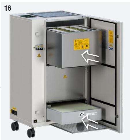
Fig. 16: Posizionare i filtri nuovi / puliti. Spingere le linguette ferma filtro verso l'interno finché non si avverte uno scatto.
