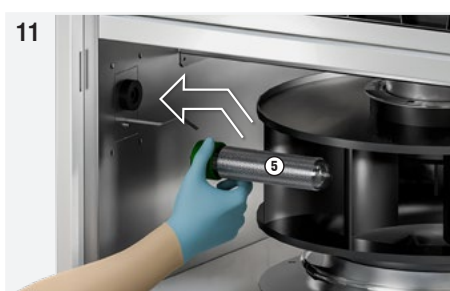
Fig. 11: Avvitare delicatamente il tubo ionizzante afferrandolo alla base (parte verde), posizionandolo nella sua sede sopra il ventilatore.
