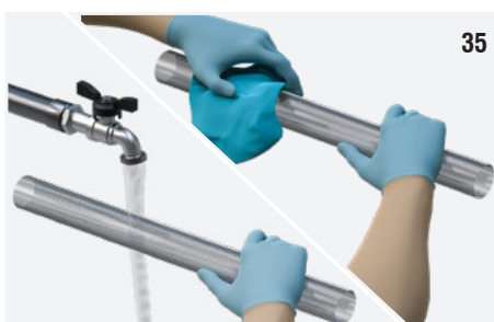
Fig. 35: Lavare la rete sotto un getto di acqua calda e asciugare accuratamente con un panno che non perda fibre.
