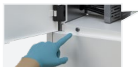
Fig. 66: Svitare le 2 viti che tengono chiuso il pannello inferiore posteriore di accesso per la manutenzione. Alzare e quindi tirare verso di se per rimuovere il pannello.
