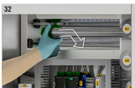
Fig. 32: Svitare delicatamente il tubo ionizzante afferrandolo alla base (parte verde). Se l'operazione risulta difficoltosa, tirare leggermente la molla di messa a terra in modo tale che non faccia contatto con la superficie del tubo.
